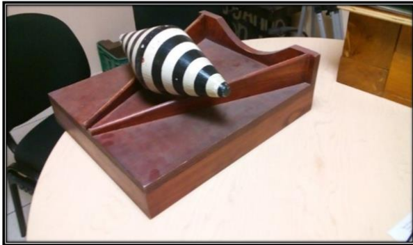
FIGURA 5. Caso más sencillo del sistema de bicono con rieles de madera, y cuyas dimensiones son de 60 x 80 x 15 en cm y un ángulo de 8 grados.
